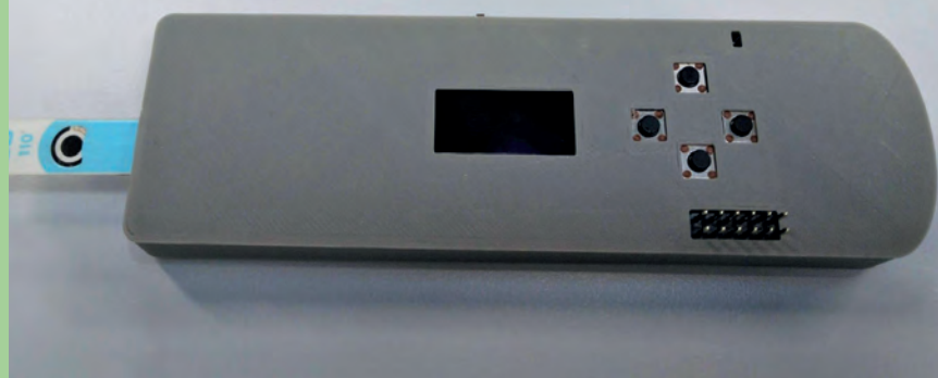
Imagen del dispositivo creado por los investigadores de la UPCT, que detecta la vitamina C. UPCT
